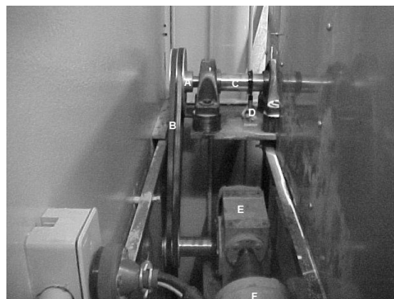
Fig 1 - Abrasômetro tipo roda-de-borracha, mostrando o sistema de transmissão: A - polia; B - correia; C - eixo; D - contagiros; E - redutor; F - motor.
