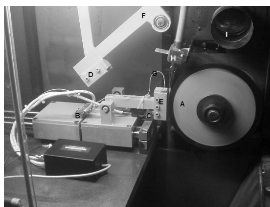
Fig 2 - Abrasômetro tipo roda-de-borracha, mostrando na foto o sistema mecânico e instrumentado: A - disco de borracha; B e C - células de carga normal e tangencial; D e E: porta-amostras dos sistemas mecânico e instrumentado; F - Braço para ensaios mecânicos; G - termopar; H - bico alimentador do abrasivo; e I - exaustor de poeira
